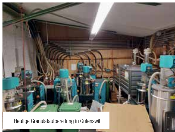
Steuerung für Granulatversorgung, sowie die Vakuumpumpe mit Filter
